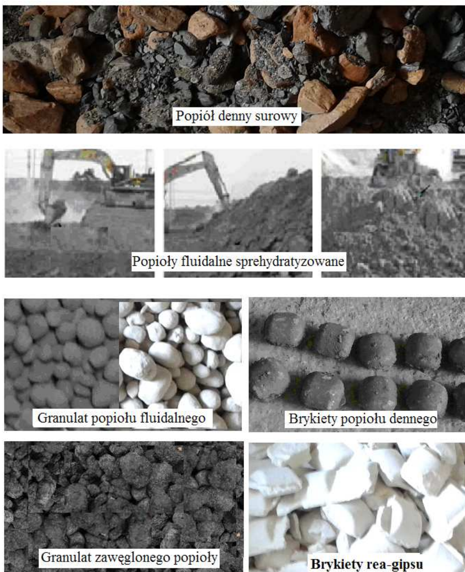
Rys. 4. Wygląd zeskalonych pylistych i drobnoziarnistych popiołów fluidalnych i rea-gipsu (źródło: T. Józefiak; N.M. Jackson; własne)
